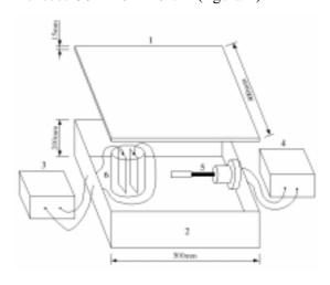
Figura 2 - Esquema do reator para fotodegradação
