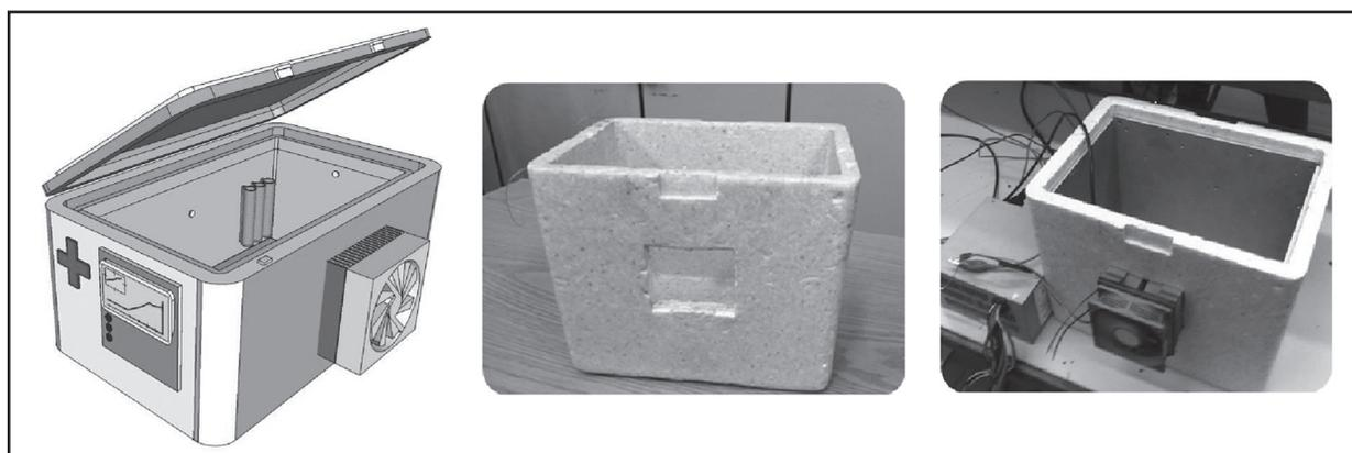
Figura 2 – Projeto do protótipo e sua construção em EPS
