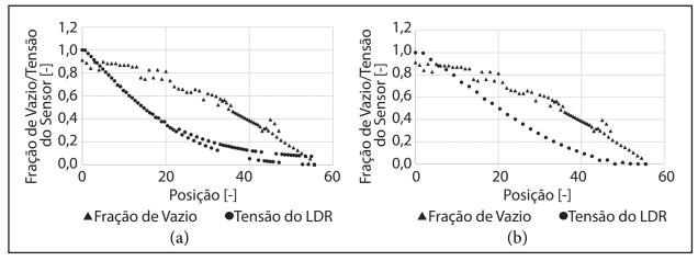
Figura 15 - Dados da fração de vazio e dos sinais de tensão equalizados para os sensores LDR (a) e de tubo, ST (b) Fonte: As autoras (2018).
