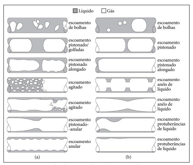
Figura 1 - Padrões de escoamento bifásico para (a) minicanais e (b) microcanais Fonte: Adaptado de Kawaji e Chung (2004).
