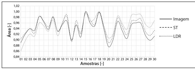
Figura 11 - Comparativo entre as áreas normalizadas das imagens bolhas e dos sinais do sensor de tubo ST e do sensor LDR para vazão de água de 100 mL/min e volume de ar de 0,1 mL Fonte: As autoras (2018).
