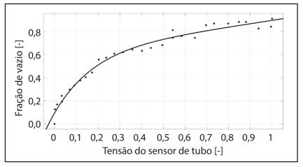
Figura 17 - Curva de calibração para sensor de tubo, ST. Fonte: As autoras (2018).
