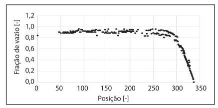
Figura 14 - Variação da fração de vazio ao longo do comprimento das bolhas de ar Fonte: As autoras (2018).
