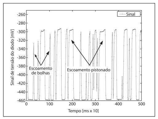
Figura 9 – Padrões de escoamento na ebulição do fluido refrigerante R-134a em um microtubo horizontal de 0,5 mm de diâmetro interno Fonte: Adaptado de Revellin *et al.* (2006).
