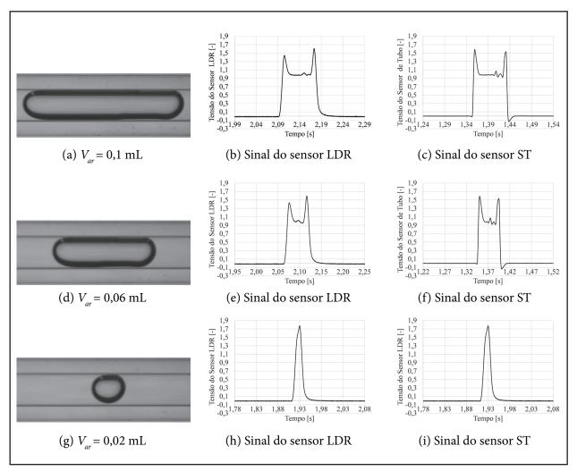
Figura 8 – Imagens dos padrões de bolhas e os respectivos sinais para os sensores LDR e de tubo para líquidos ST Fonte: As autoras (2018).
