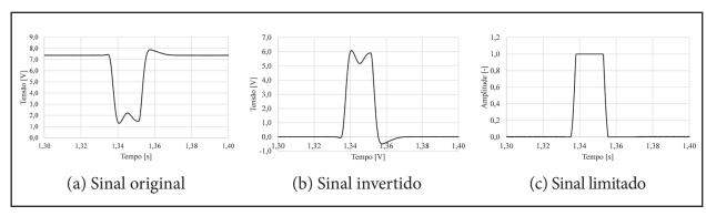
Figura 6 - Etapas do processamento dos sinais dos sensores Fonte: As autoras (2018).
