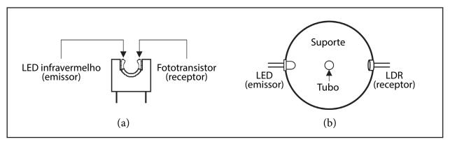
Figura 3 – Ilustração do (a) sensor de tubo – ST e do (b) sensor LDR Fonte: As autoras (2018).
