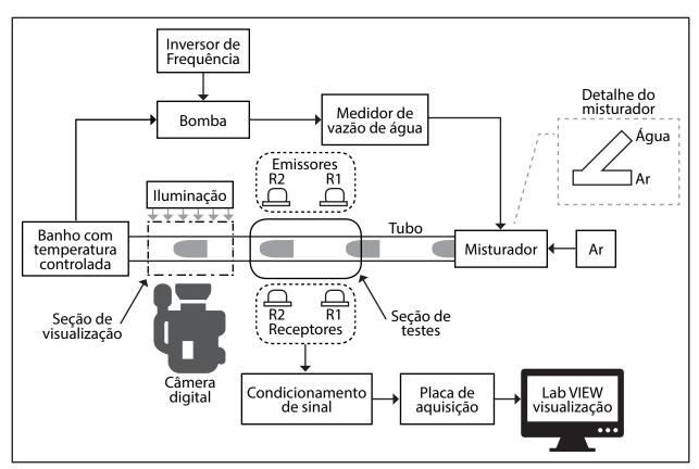
Figura 2 - Esquema da bancada de testes para estudos de escoamento bifásico Fonte: As autoras (2018).
