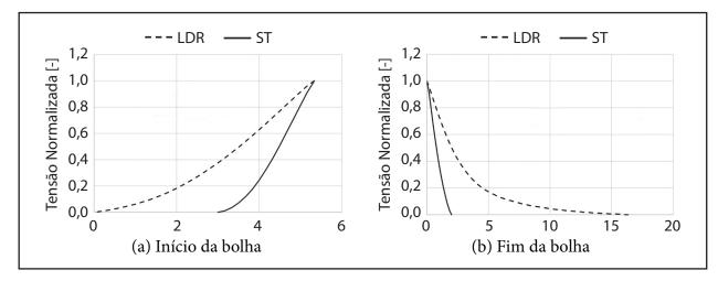
Figura 12 – Inclinação da curva dos sinais dos sensores LDR e de tubo ST para as transições (a) água-ar e (b) ar-água Fonte: As autoras (2018).
