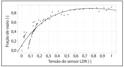
Figura 16 - Curva de calibração para o sensor LDR Fonte: As autoras (2018).
