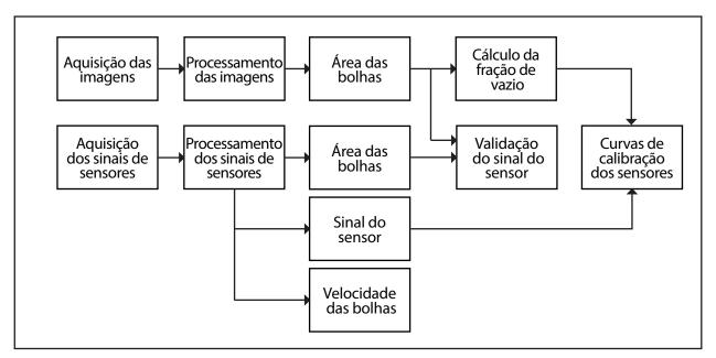
Figura 4 – Principais etapas da metodologia empregada para validação e calibração dos sensores ópticos Fonte: As autoras (2018).
