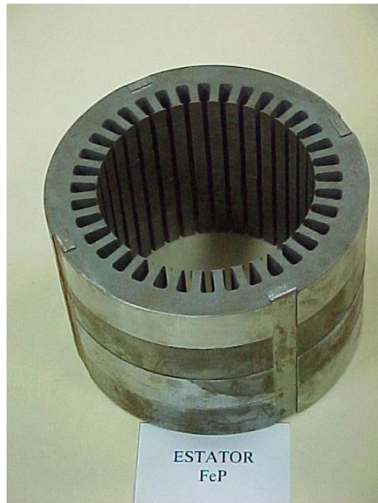
Fig. 3 - Núcleo do estator sinterizado liga FeP de um motor de indução
