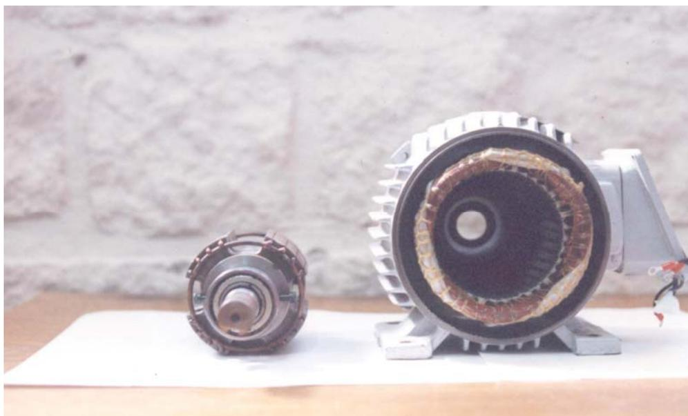
Fig. 2 - Vista frontal do conjunto rotor, carcaça do motor de relutância
